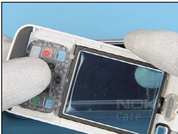
14. Insert the FUNCTION KEYMAT.
